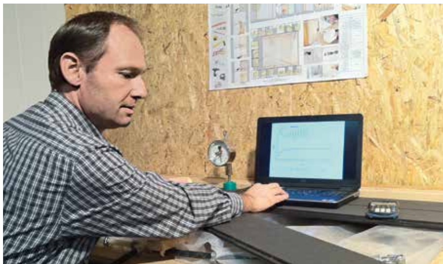
Daniel Friedrich untersucht ein Fassadenpanel, das aus Pflanzenfasern und Kunststoff besteht, auf seine Durchlüftungseigenschaften.
