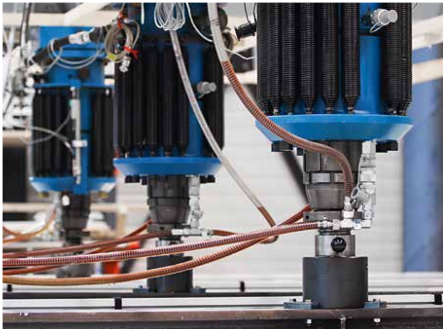
Drei Hydraulikpressen erzeugten zehn Millionen Mal ein Gewicht von 27 Tonnen.
