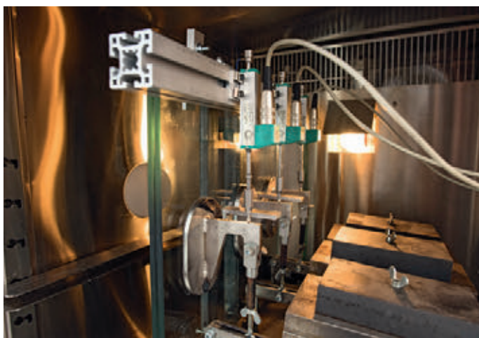
Auf Glas geklebte Stahlhalter werden im Klimaschrank einer Belastungsprüfung unterzogen.
