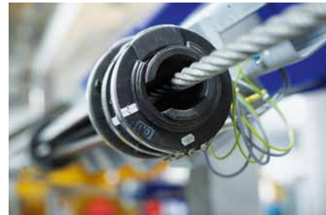
Das Zugseil ist der Übertragungskanal für Daten und Signale.
