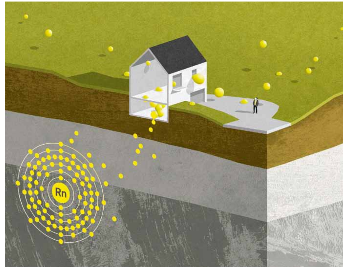
Radon entsteht beim Zerfall von Uran im Boden und kann über undichte Fundamente in Wohnräume gelangen und sich dort anreichern.
